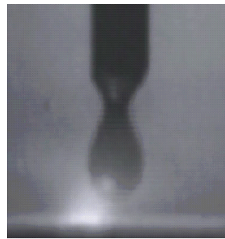
شکل ۱ حرکت قطره مذاب از الکترود به طرف حوضچه جوش
