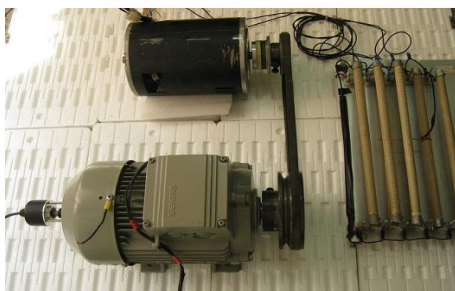
شکل ۲۴ موتور سه‌فاز، ژنراتور DC و بار
