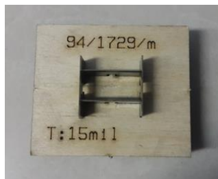
Fig. 2. Schematic of the die cut mold ( 10.16 \times 22.86 \text{ mm}^2 ).
