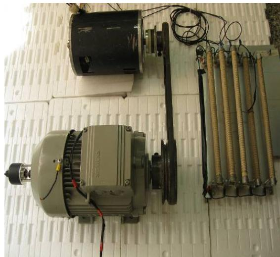
شکل ۱۹ موتور سه‌فاز، ژنراتور DC و بار
