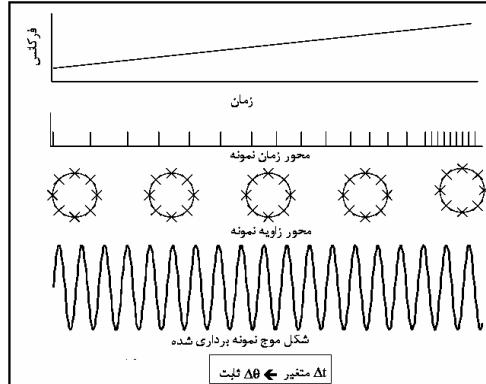
شکل ۷ سیگنال سینوسی با فرکانس متغیر که با  $\Delta t$  ثابت نمونه‌برداری شده است
