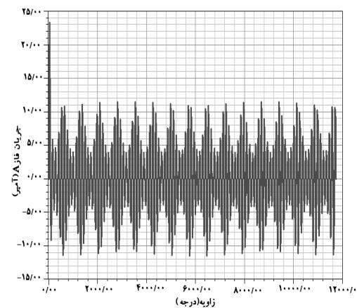
شکل ۱۱ جریان موتور با رotor دارای عیب لنگی در حالت بار متغیر
